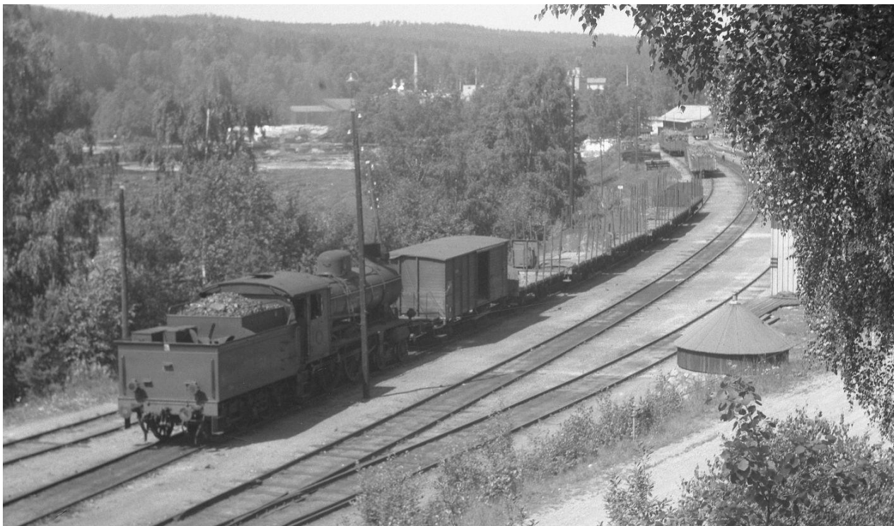
Ett lok littera A6 växlar tomvagnar på okänd plats. Tågsettet består av en täckt vagn littera Gs följt av två Os, en standard littera O med 9 par stolpar, en till Os, och längst bort två till littera O. Längre bort på spåren skymtar fler O/Os/Or-vagnar lastade med virke. Foto av Lars Ekeröth 1940. JvmKBED00059
