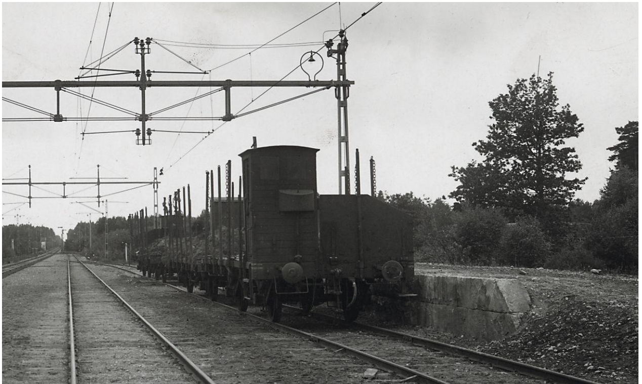
Vagnar på okänd bangård. Närmast en Os-vagn med tryckluftsbröms och bromshytten kvar. Bakom den en Or med lutande tak på bromshytten och bortanför det två till Os. Foto av C. Järnmark runt 1930. JvmKDAF02940
