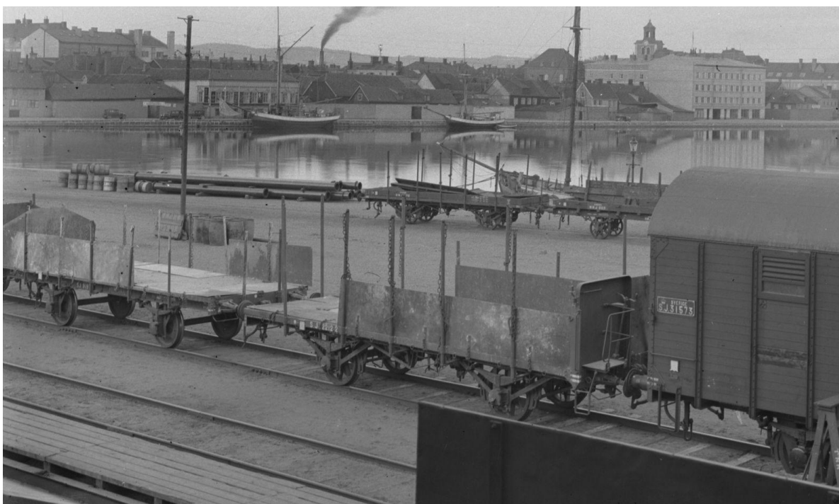
SJ Os 22122 i Jönköping med borte gavellämmen infälld och bortesta sidoplåtarna infällda. Till vänster i bild SJ Nm 9191(?), en äldre modell av godsvagn som byggts om till något liknande en Os. Till höger syns Grh 31573. Foto någon gång 1930-40-tal. JvmKBEB01211
