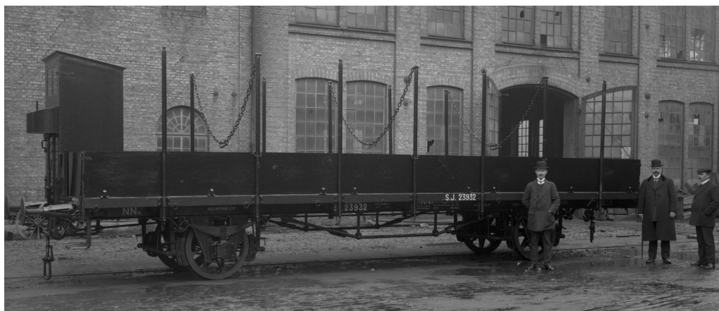
Leveransbild från 1914 på storasyskonet NN4 23932 som har låga plåtlämmar med raka gavlar, likt hur de NN3 vagnar som först fick plåtlämmar såg ut. Dessa NN4 litterades senare om till Or. JvmKAGB00049
