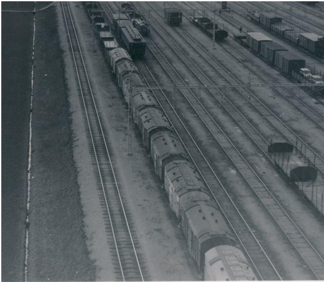
Lång rad med Hs-vagnar på Hallsbergs rangerbangård, våren 1936. Bilden visar tydligt de olika varianterna av takluckor som fanns. Varannan vagn har isbehållare i gavlarna vilket syns på de dubbla luckorna i vardera gavel, varannan vagn har isbehållare längs hela takåsen. Notera att vissa vagnar med isbehållare i taket har kvar sina större, dubbla luckor i ändarna. JvmKDAA02708:01
