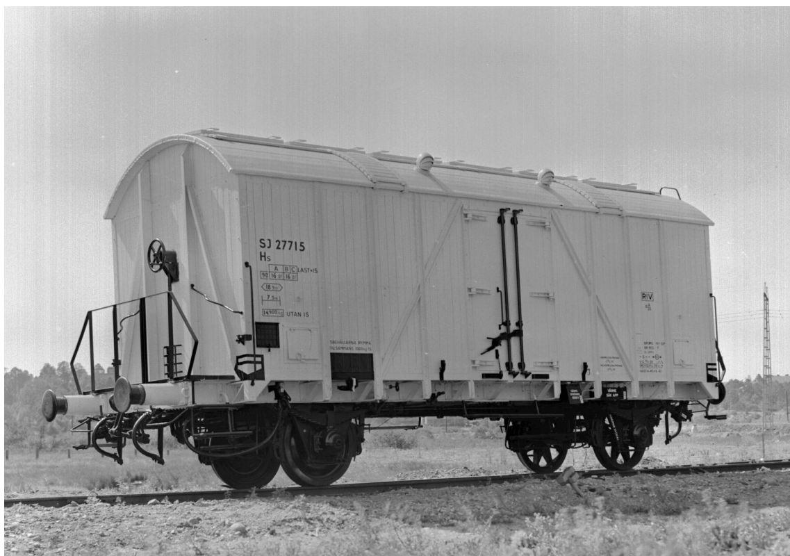
SJ Hs 27715 nyombyggd med förstärkt korg med snedsträvor på kort- och långsidorna, samt nya viktörrar. Foto av J.N. Gylldorf i juni 1959. JvmKBDB09498
