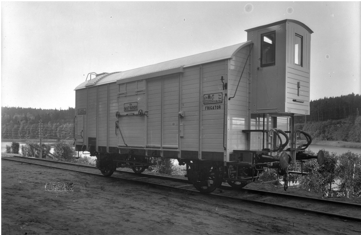
Leveransfoto på H3 26229 sommaren 1910. Vagnen har kylsystem Frigator, vilket också anges under litteraskylten. Isbehållare enbart i borte änden av vagnen där man kan skymta påfyllningsluckan på taket. Alla H3 hade upphöjda bromshytter från leverans enligt tysk modell. JymKAGB00017
