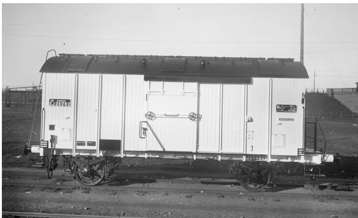
Foto på en nyombyggd SJ Hs 26262 som försetts med ny korg med stående panel och nedtagen bromshytt som ersatts med en plattform. Isbehållare med luckor längs med hela taket. Foto februari/mars 1931. JvmKAFN00258
