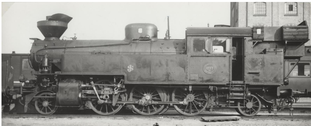
SJ Sa 1277 ombyggd för vedeldning. Foto från tidigt 40-tal. Notera förlängningen på bakre buffertbalken för att ge plats åt vedhäcken.
